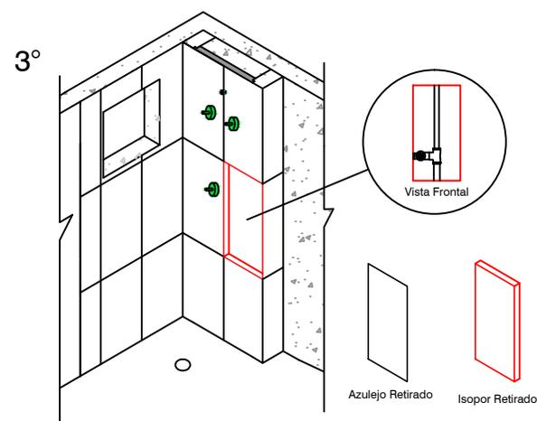
Retirar a cerâmica do ponto de manutenção e fazer o corte do isopor com o auxílio de uma lamina de mão (starret).
