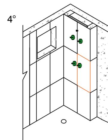
Reinsere Isopor, com o auxílio de espuma expansiva.
